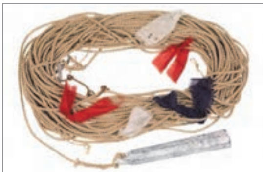
شکل ۱۴- نوعی عمق‌یاب یا بِلت دستی با وزنهٔ سربی و طناب علامت‌گذاری شده
