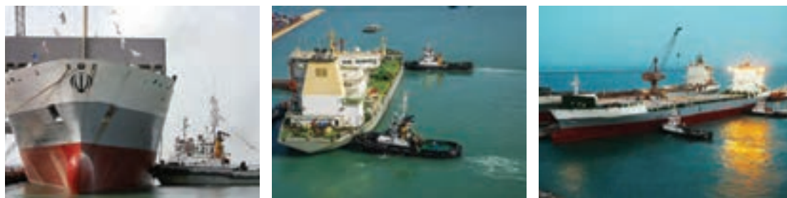
شکل ۲۹- عملیات یدک‌کشی پهلوبه‌پهلوی
