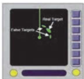
شکل ۱۶- نمایش پژواک‌های جانبی در صفحه نشانگر رادار
