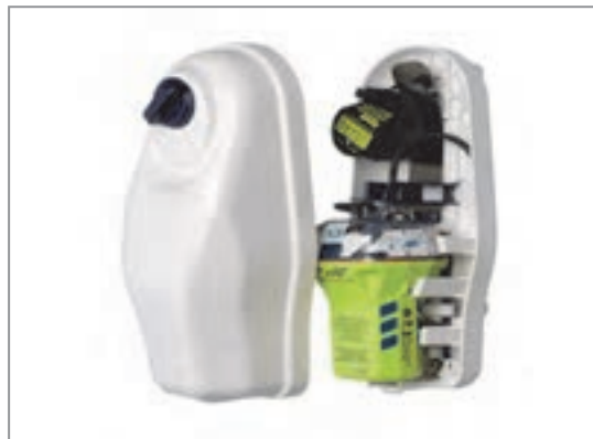
شکل ۱۸- EMERGENCY POSITION INDICATING RADIO BEACON
