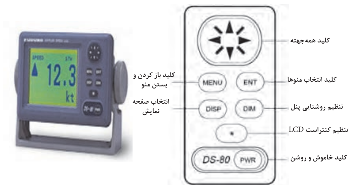
شکل ۳۱- نمای کلی کلیدهای کنترل سیستم سرعت سنج
