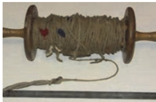
شکل ۱۴- نوعی عمق‌یاب یا بِلت دستی با وزنهٔ سربی و طناب علامت‌گذاری شده
